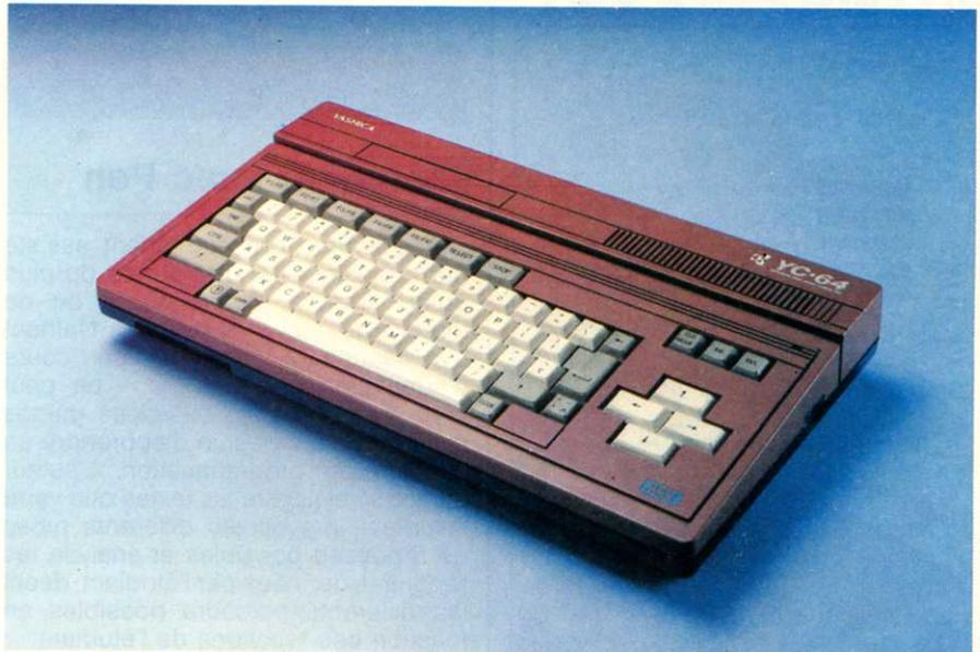
**Segimex (Tél. 1/562.03.03) distribue le micro Yashica MSX YC 64 (mémoire vive 64Ko). Il est vendu avec un câble péritel et un cordon cassette au prix de 3 950 F. Le système d'exploitation proprement dit, ainsi que le MS-X basic est contenu dans une mémoire morte de 32Ko.**
